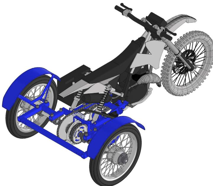
**Figura 1.** Representação esquemática da motocicleta, adaptada com kit triciclo, para tracionar cultivadores.
