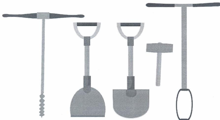
**Figura 2.** Ferramentas para a coleta manual de amostras de solo.
