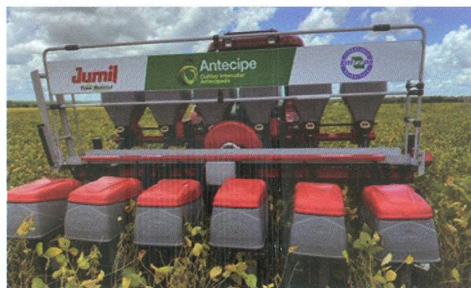
*Figura 1. Semeadora-adubadora desenvolvida para o sistema Antecipe durante operação de semeadura do milho nas entrelinhas da soja em Uberlândia/MG.*
