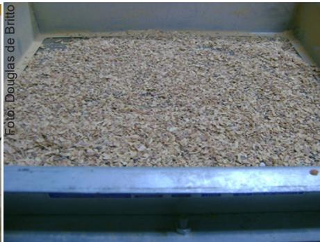
**Figura 3.** Processado de sementes de algarobeira (*Prosopis juliflora* (SW) DC) e frações do endocarpo após trituração no moinho de bolas e separação por peneiras.
