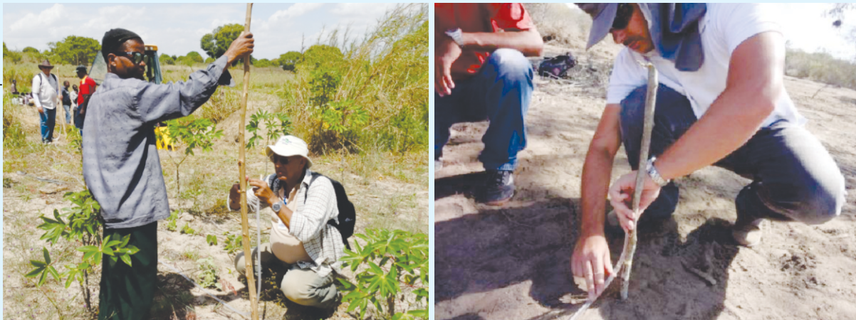
Figura 11. Medição do nível com mangueira.
