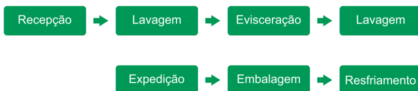
Figura 3. Fluxograma operacional do processamento da tilápia no EMP.
