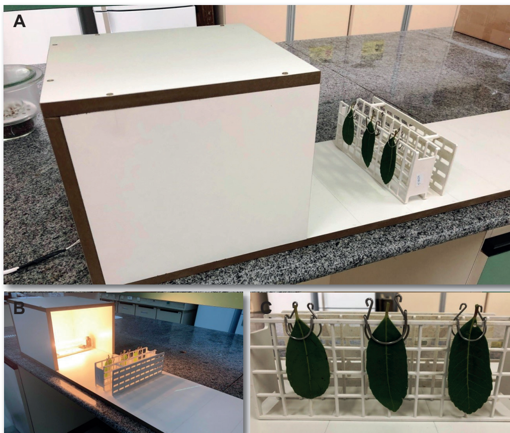
Figura 3. (A) Estrutura construída com MDF, no formato de caixa contendo a lâmpada com luz infravermelha e a grade contendo as amostras de folhas de erva-mate. (B) Experimento com as folhas de erva-mate na distância 35 cm da fonte de luz infravermelha, expostas por 20 minutos. (C) Detalhe da grade contendo as amostras de folhas.
