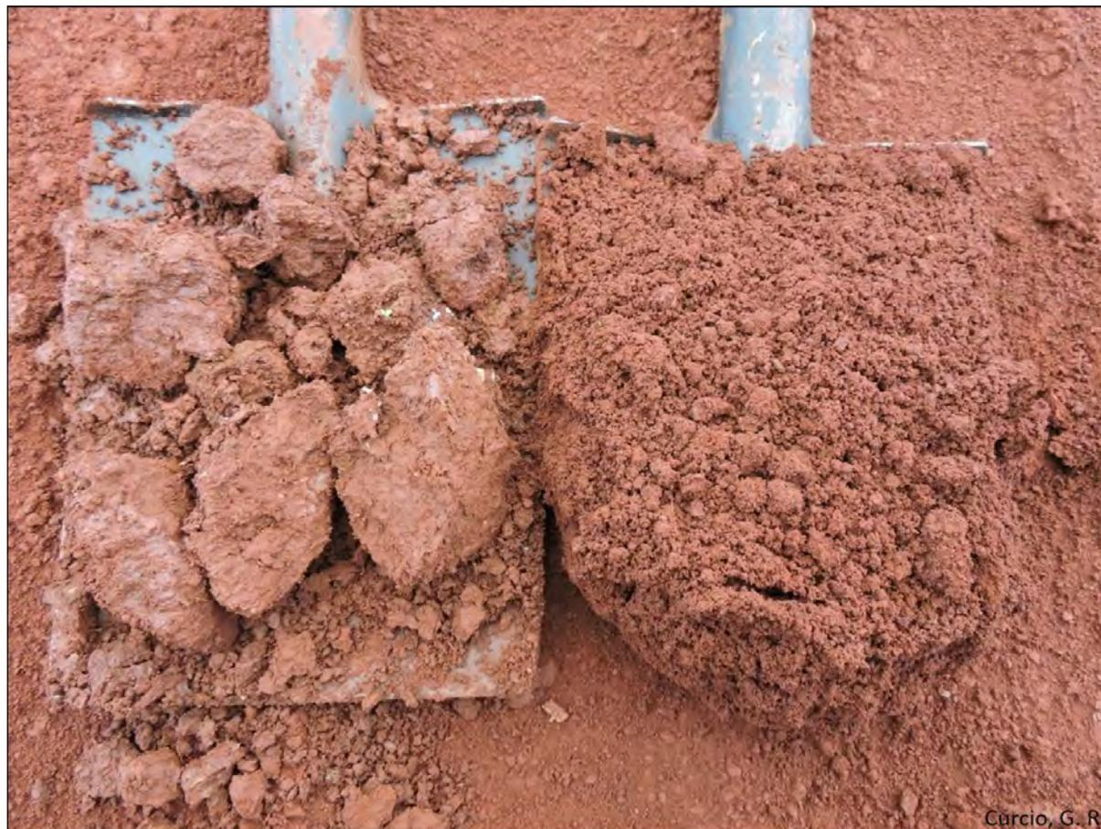
Figura 15 - Horizonte BA de Latossolo Vermelho fortemente compactado e horizonte Bw2 com estrutura granular.
