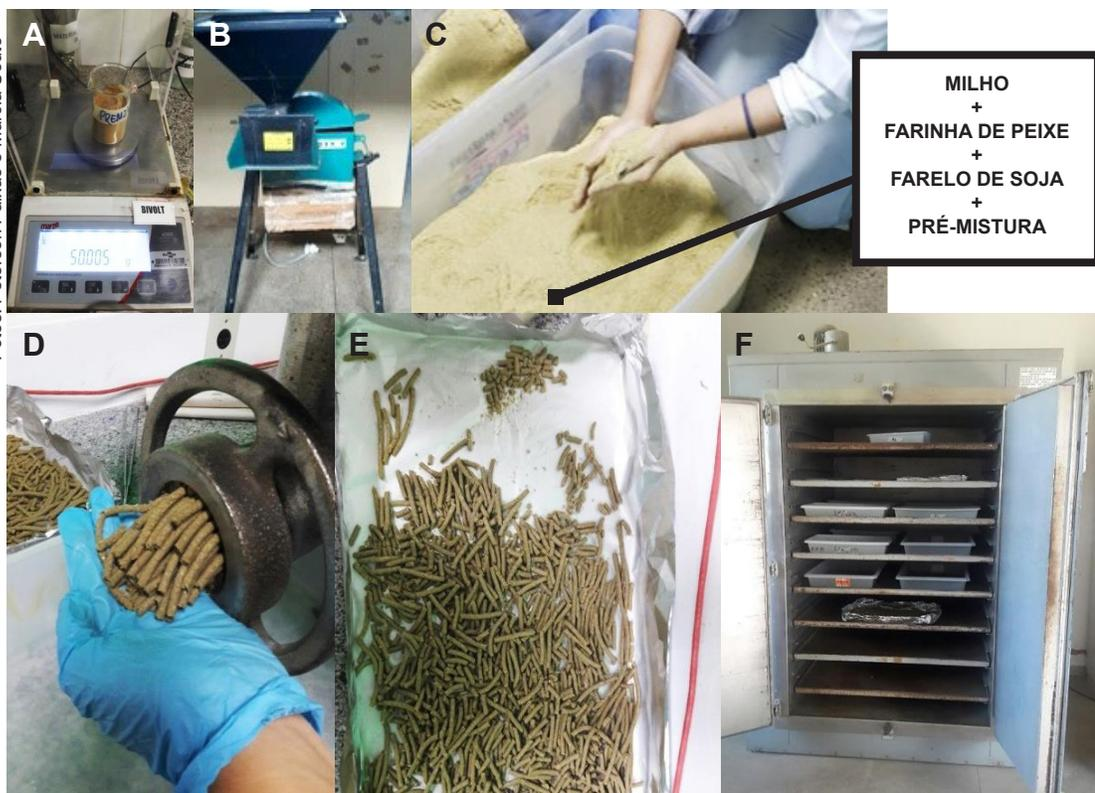
**Figura 1.** Preparo artesanal da ração com óleo de coco. (A) Pesagem dos ingredientes; (B) Moedor para trituração dos ingredientes; (C) Mistura dos ingredientes; (D) Mistura úmida e pré-aquecida passando pelo moedor de carne para formação de pellets; (E) Ração peletizada artesanalmente; (F) Secagem da ração em estufa.
