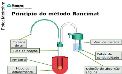
**Figura 2.** Esquema ilustrativo do princípio de funcionamento do aparelho Rancimat.
