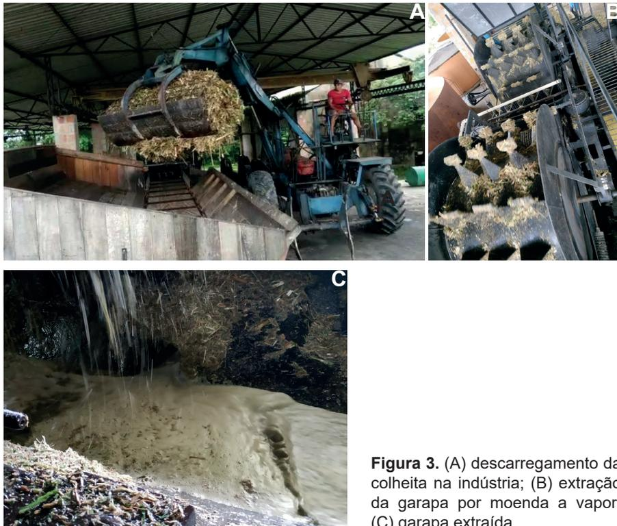
**Figura 3.** (A) descarregamento da colheita na indústria; (B) extração da garapa por moenda a vapor; (C) garapa extraída.
