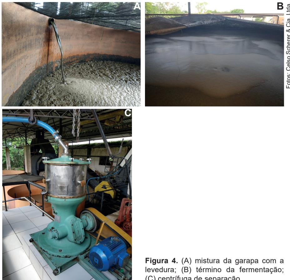
**Figura 4.** (A) mistura da garapa com a levedura; (B) término da fermentação; (C) centrífuga de separação.
