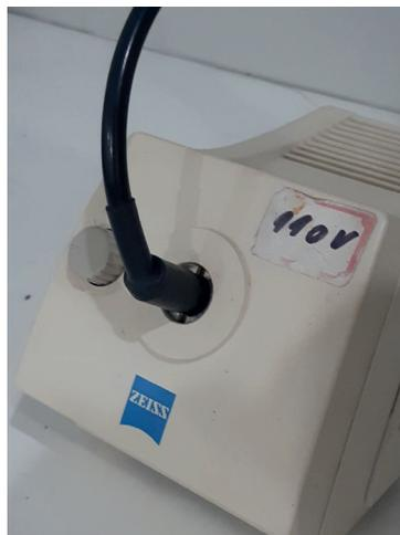
**Figura 2.** Fonte de alimentação para o estereomicroscópio Zeiss.
