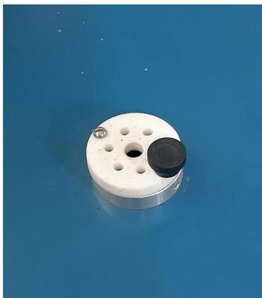
**Figura 2.** Entrada para o termômetro de mercúrio.
