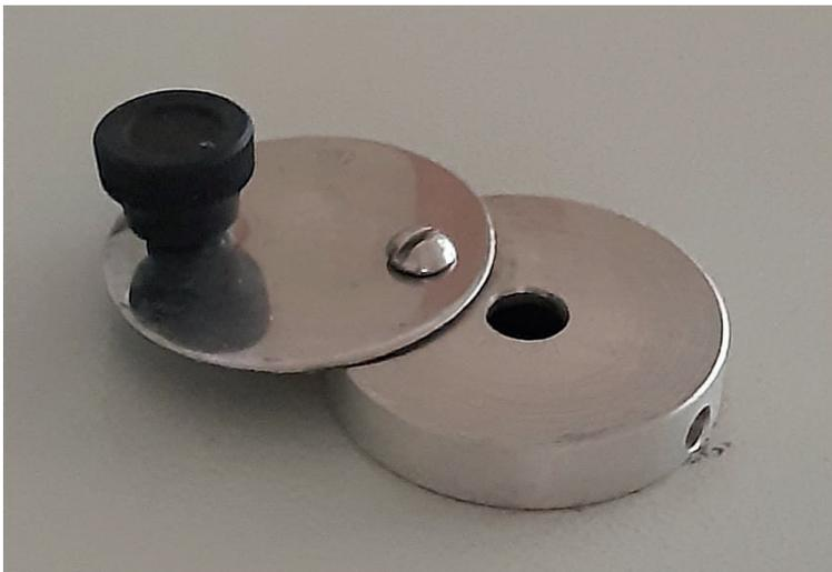
**Figura 3.** Entrada para o termômetro de mercúrio.
