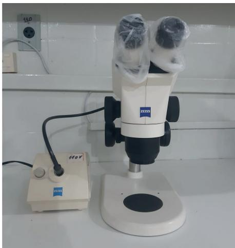
**Figura 1.** Estereomicroscópio Zeiss e a fonte de iluminação.
