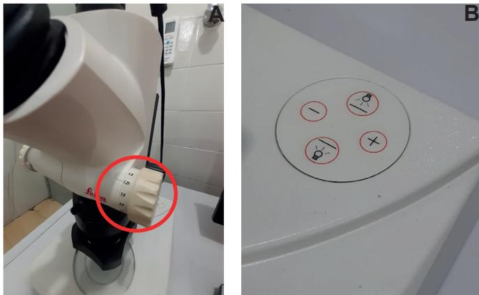
**Figura 3.** Ajuste do aumento (A) e ajuste da iluminação (B).
