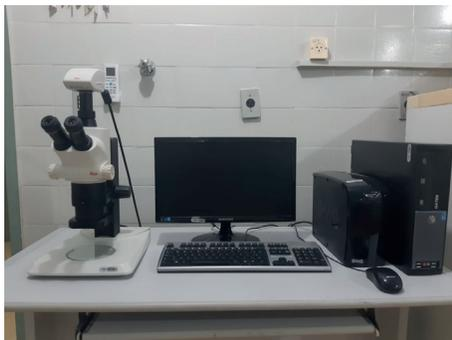
**Figura 1.** Estereomicroscópio Leica S8 APO acoplado ao computador.
