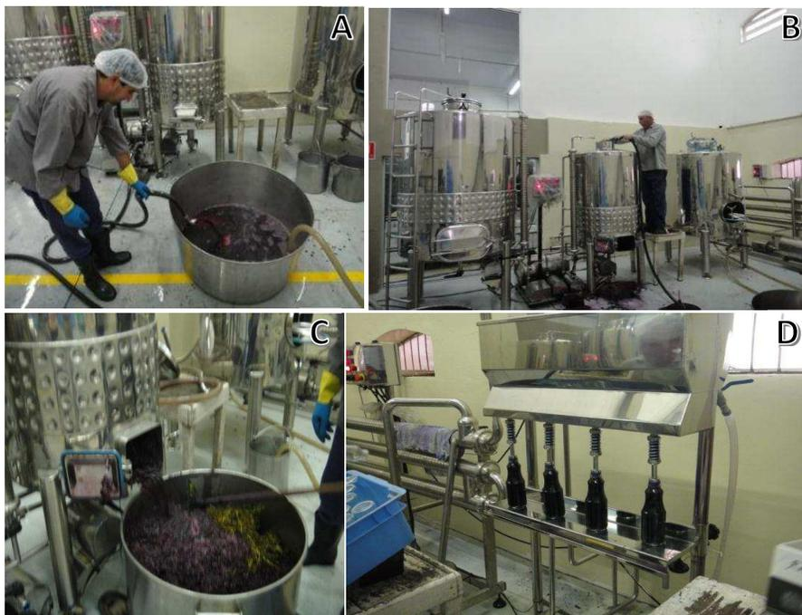
**Figura 4.** Processamento da uva de modo industrial, no Laboratório de Inovação Enológica da Embrapa Uva e Vinho, expondo o bombeamento (trasfega) do recipiente de aço inoxidável (A) para o tanque onde o suco foi produzido pelo sistema de troca térmica (B). Em (C), destaca-se o bagaço de uva retirado do tanque após o término da elaboração do suco de uva e, em (D), a etapa de engarrafamento do suco após a pasteurização.
