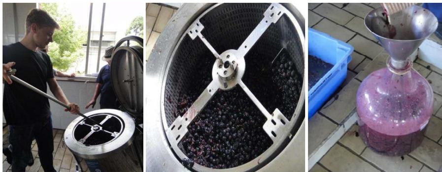
**Figura 3.** Processamento da uva com o suquificador e o suco vertido para o garrafão de 20 L.
