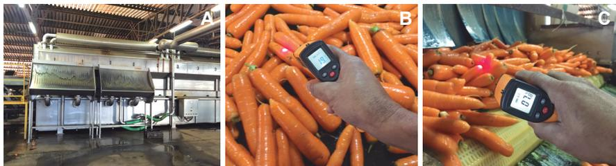
**Figura 28.** A) *Hydrocooler*, B) Temperatura das raízes antes do *hydrocooler* (19 °C), e C) Temperatura das raízes após *hydrocooler* (7 °C).
