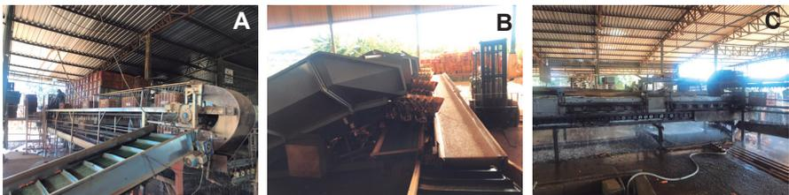
**Figura 26.** A) Depósito manual das caixas plásticas, B) Depósito mecânico de raízes, e C) Esteira de escovas de *nylon*.
