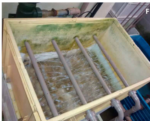
Figura 61. Filtro biológico: com mídias fluidizáveis compostas por recortes de conduítes com 30 mm (A); com mídias de nanoesferas em camadas semi-inundadas ou dry-wet (B); filtro rizosférico (C); detalhe da drenagem do filtro rizosférico para o tanque de abastecimento (D); filtro dry-wet (E); detalhe de compartimento com lã filtrante no filtro dry-wet (F).
