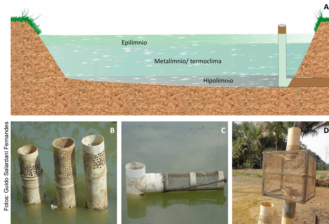
Figura 32. Sistema de drenagem: corte longitudinal de viveiro com cachimbo interno e tubulação sob talude (A); ponteiros de tubo do cachimbo interno para evitar fuga de alevinos (B, C e D).
