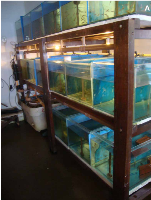
Figura 38. Sistema de drenagem de água: vista panorâmica da estante com os aquários e sistema de filtro (A); detalhe do tubo de PVC ocre com adaptação para evitar perda de juvenis na drenagem (B).
