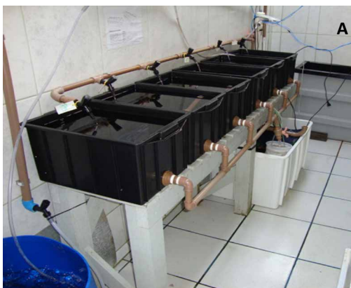
Figura 15. Produção de cavalo-marinho em estrutura in door em um empreendimento no estado do Espírito Santo: aquários de manutenção de matrizes em sistema de recirculação de água (A); vista do comportamento das matrizes em substrato feito com fita plástica presa a pedaço de vidro (B); vista frontal de aquário e sistema de abastecimento e drenagem (C); vista panorâmica da bateria de aquários no momento da alimentação (D).
