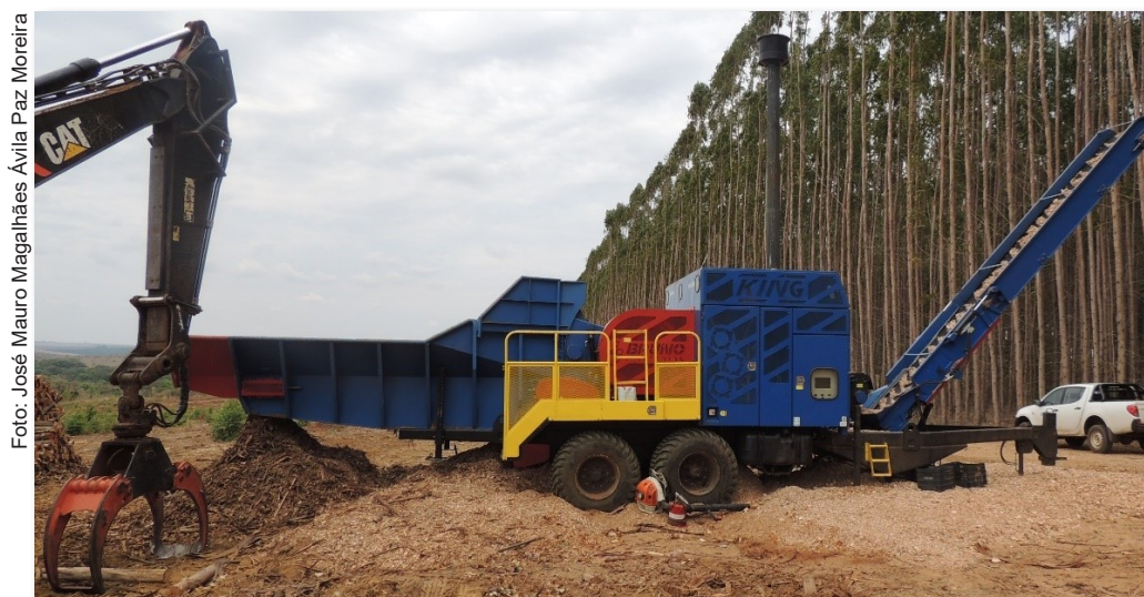
Figura 5. Equipamento utilizado para a picagem da madeira de eucalipto, em talhão comercial no município de Cristalina, Goiás.
