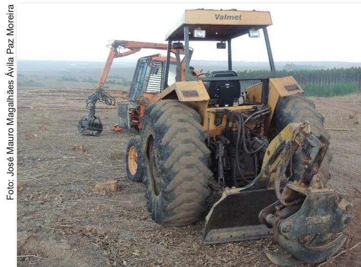
Figura 4. Equipamentos para arraste mecanizado de toras de eucalipto utilizados no município de Cristalina, Goiás.
