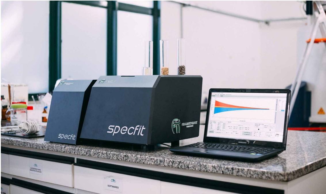
SpecFIT – equipamento de ressonância magnética nuclear (RMN) comercial para análise de matérias-primas e produtos alimentícios.
