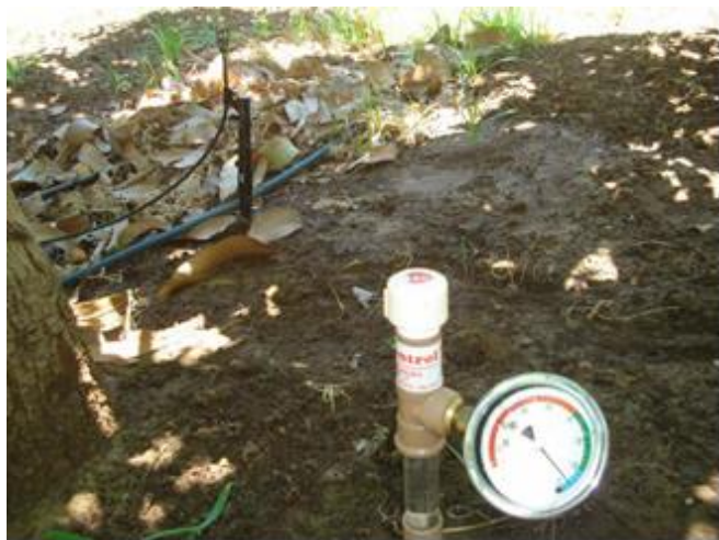
Figura 1. Tensiômetro para medida do potencial da água do solo.
