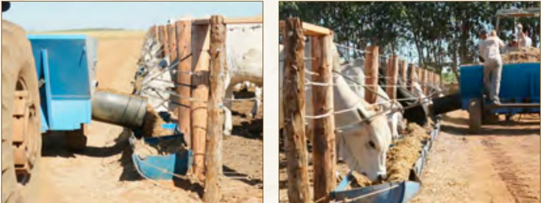
**Figura 8.** Distribuidora simples de ração montada em trator em operação em URT de ILPF.
