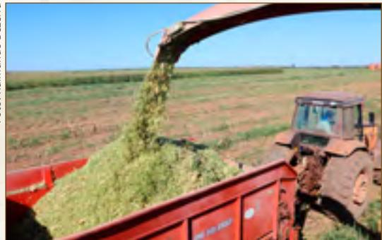
**Figura 6.** Colheitadeira de grãos adaptada colhendo sorgo forrageiro para silagem, acompanhada de trator com carroceria para o transporte até o silo-bolsa.
