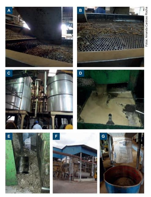
**Figura 1.** A: Passagem do material pela peneira; B: Peneira com resíduos; C: Aquecimento e prensagem do material; D: Óleo obtido após a prensagem; E: Torta de mamona obtida após a prensagem; F: Usina para extração por solvente do óleo residual da torta de mamona; G: Farelo de mamona industrialmente destoxificado.
