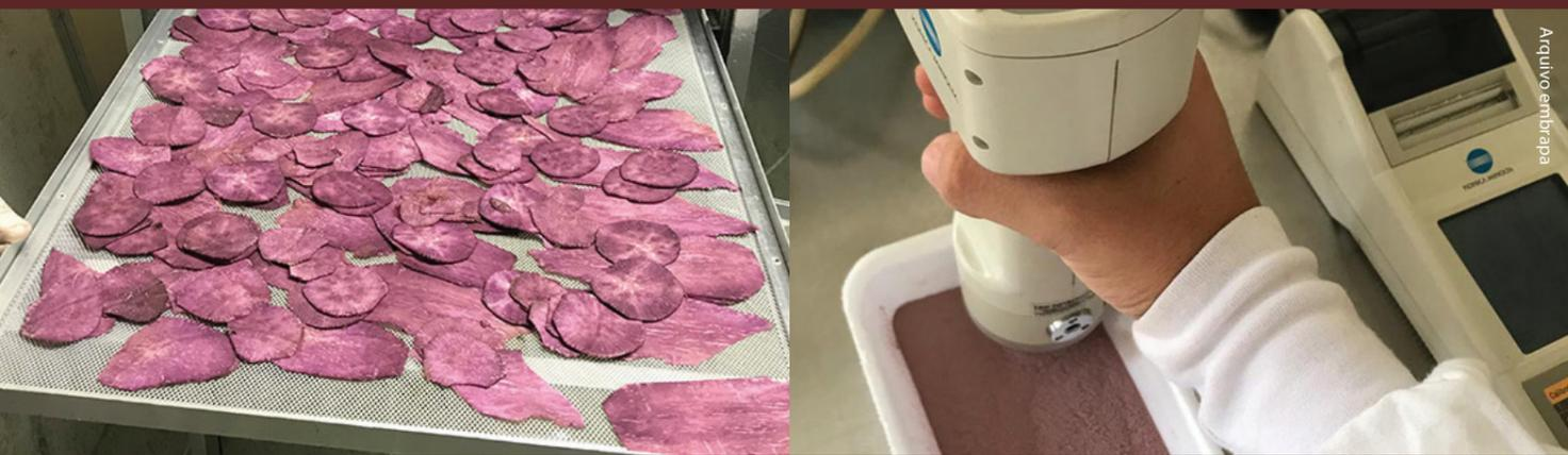
congeladas a  $-18^{\circ}\text{C}$  em freezer e, no liofilizador, havia um aumento de  $5^{\circ}\text{C}$ , a cada duas horas, até a temperatura atingir  $35^{\circ}\text{C}$ . Terminado o processo de secagem, cada amostra foi triturada em moinho para obtenção da farinha e armazenada em embalagens laminadas, na ausência de luz e umidade.
