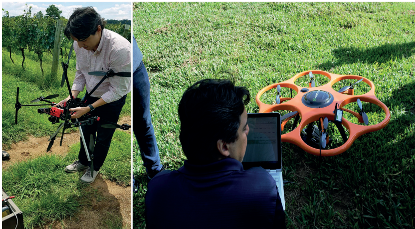
Figura 1. Câmeras multiespctrais e termais embarcadas em aeronaves remotamente pilotadas para a estimativa de evapotranspiração em vinhedos na Serra Gaúcha.
