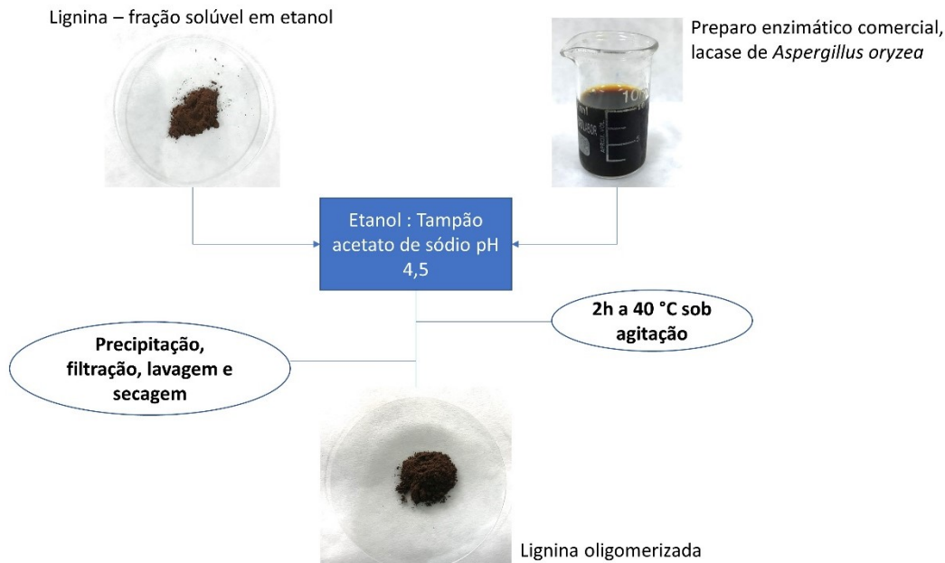
Figura 1. Processo de oligomerização da lignina kraft. O preparo enzimático comercial possui estabilizadores enzimáticos com a lacase, os quais atribuem a cor marrom à mistura, semelhante à lignina.
