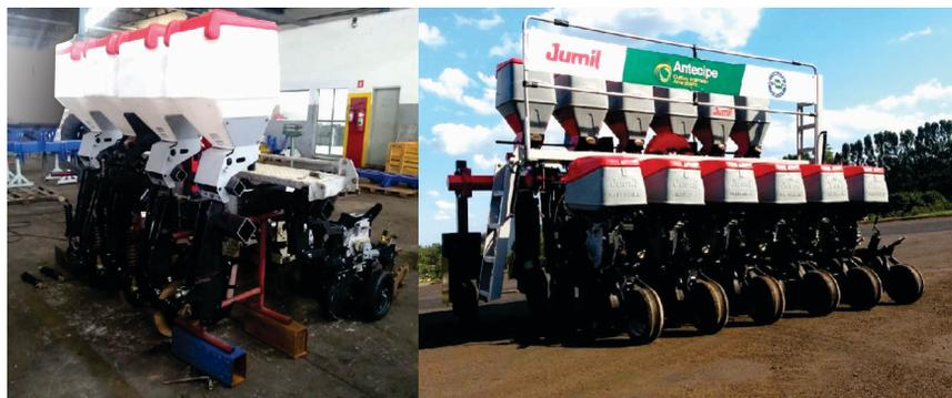
**Figura 5.** Modelo industrial de semeadora-adubadora em parceria Embrapa-Jumil, para utilização no sistema de semeadura intercalar antecipada de milho.
