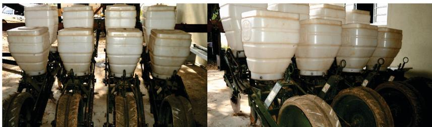
**Figura 4.** Protótipo de semeadora-adubadora desenvolvido na Embrapa Milho e Sorgo, Sete Lagoas, MG.
