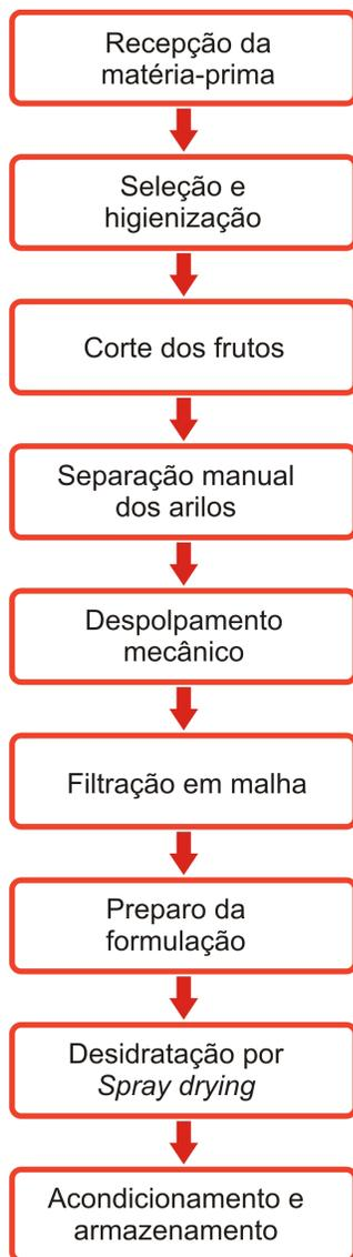
**Figura 1.** Diagrama das etapas de processo para obtenção do suco de romã em pó.
