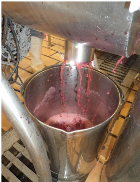
Figura 4. Despolpamento mecânico.
