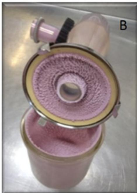
Figura 6. A: Processamento em *Spray dryer*, B: Produto em pó obtido no *spray dryer*.
