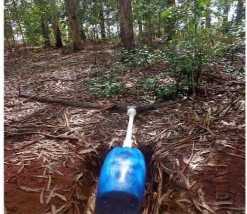
Figura 1. Modelo de parcela simplificada de perda de solo e água.
