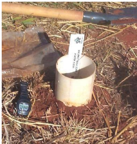
Figura 2. Anel simples para medição de infiltração de água no solo.
