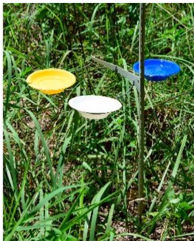
Figura 4. Armadilhas do tipo pan-trap dispostas no campo para captura de abelhas.
