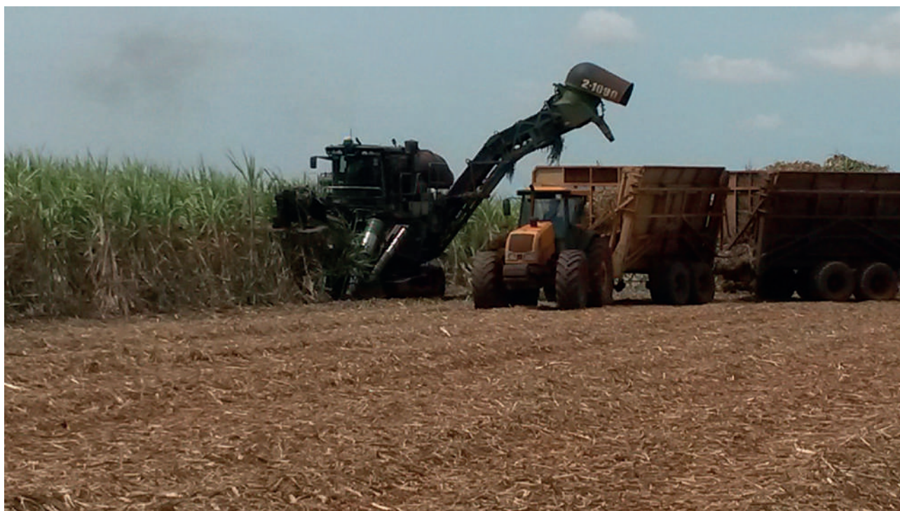
Figura 8. Exemplo de maquinário com pneus de alta flutuação e tráfego sistematizado.
