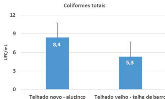
**Estimativa da concentração média (com desvio padrão) de coliformes totais analisados em dois diferentes tipos de telhados, durante o período de 30 dias.**
