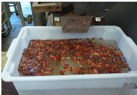
Figura 5. Trituração em moinho de facas mostrando cascas que flutuam na água e endospermas que se sedimentam ao fundo.
