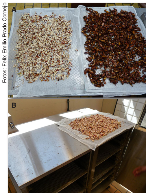
Figura 7. A) Cascas e endospermas separados; B) secagem do endosperma em secador de ar forçado, temperatura do ar 50 °C, velocidade 0,5 \text{ m s}^{-1} , por 18 a 24 horas.
