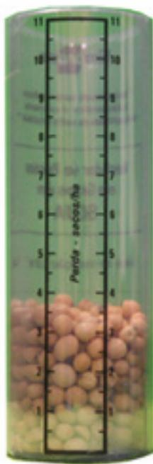
**Figura 2.** Copo medidor desenvolvido pela Embrapa para a determinação das perdas de grãos na colheita de soja, indicando o nível tolerável (1 saco/ha) e o desperdício de aproximadamente 2,5 sacos/ha.
