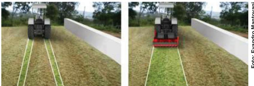
**Figura 1.** Detalhe das rodas do trator e rolos compactando a forragem e da largura do silo. Fonte: Nogueira Máquinas Agrícolas (2020).
