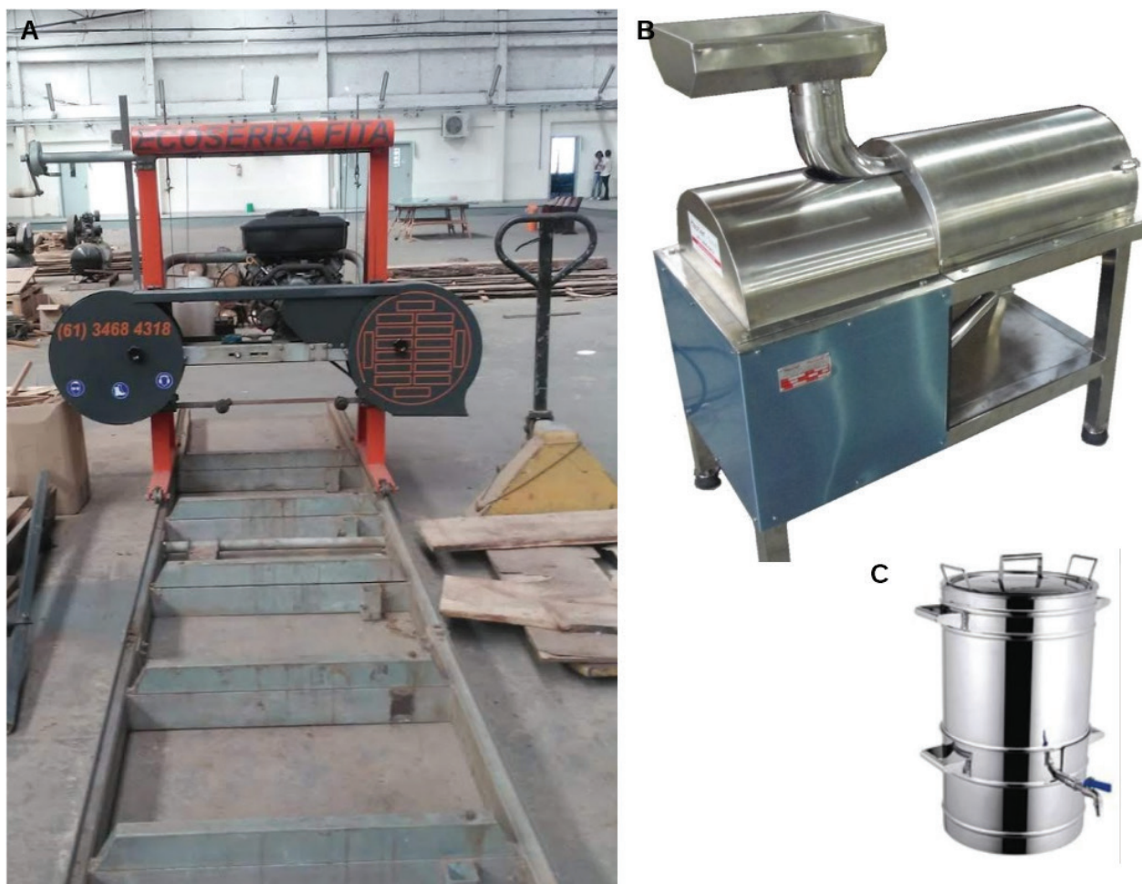
Figura 6. Equipamentos pós-colheita em SAFs. A) Serraria móvel; B) despoldadeira; C) painha de arraste a vapor.
