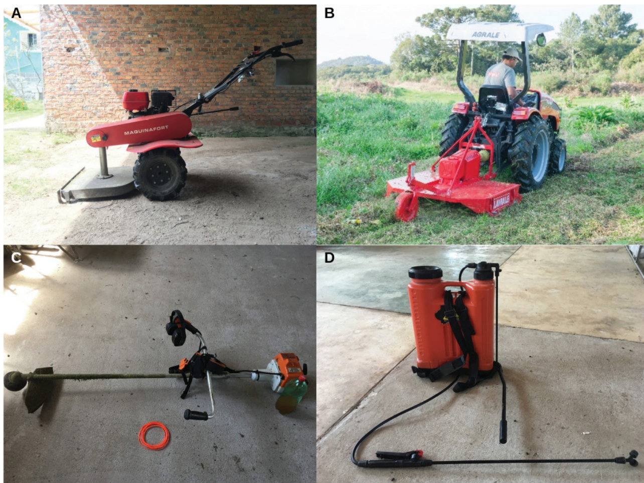
Figura 4. Implementos para a manutenção de SAFs. A) Microtrator (tratorito, motocultivador); B) trator com roçadeira acoplada; C) roçadeira costal; D) bomba costal.
