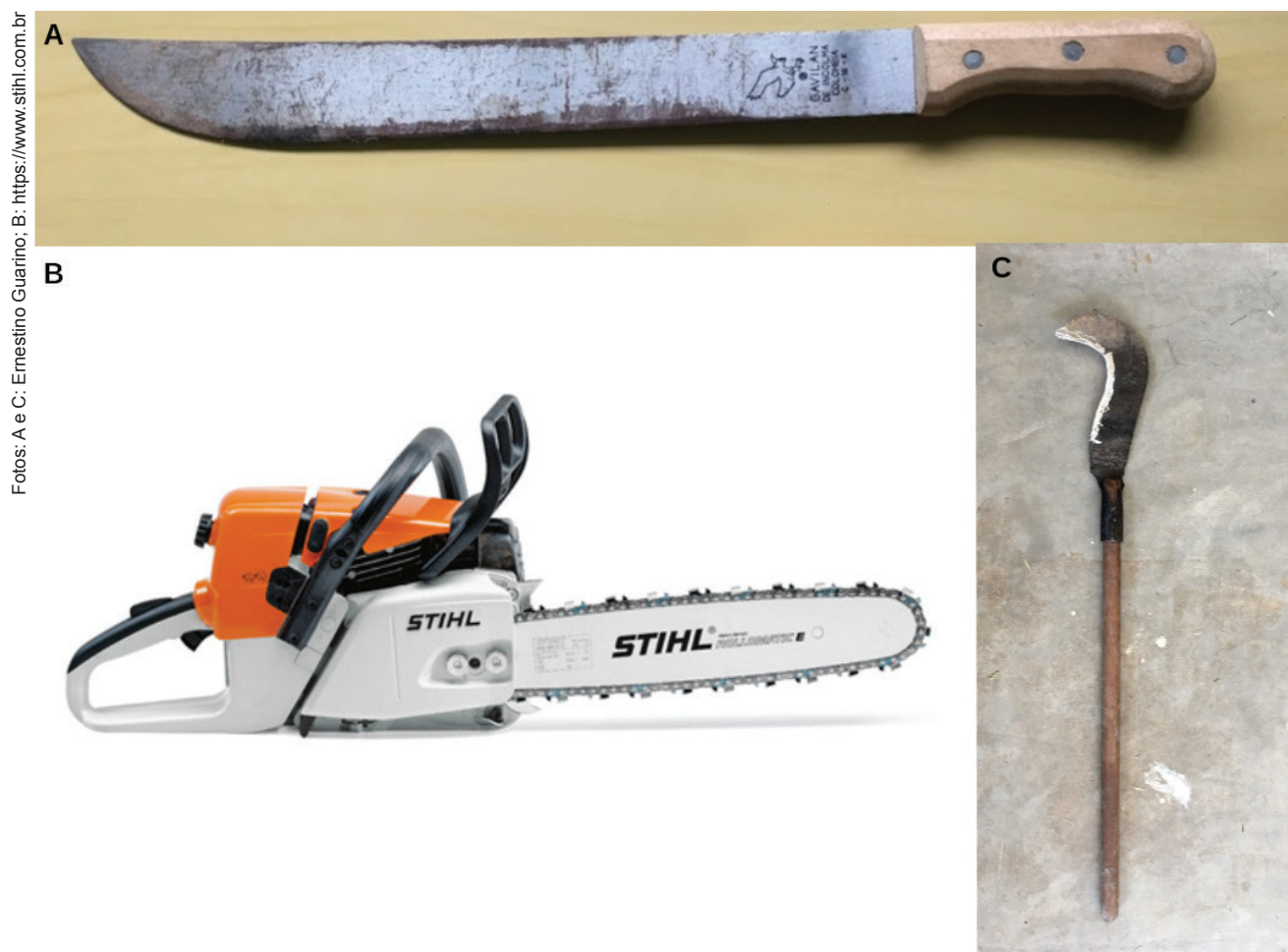
Figura 3. Implementos para limpeza de áreas em SAFs. A) Facão; B) motosserra; C) foice.
