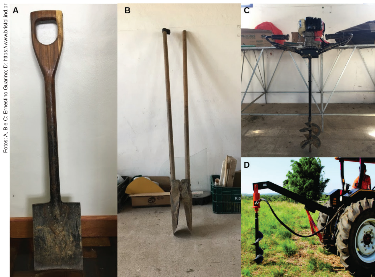
Figura 1. Equipamentos usadas para implantação de SAFs. A) pá de corte; B) cavadeira “boca de lobo”; C) broca perfuratriz acoplada a motor a gasolina; D) broca perfuratriz para acoplar em trator.
