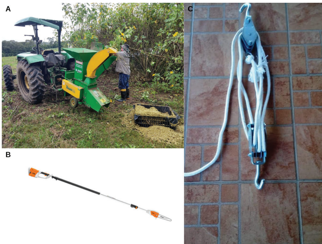
Figura 5. Equipamentos para manejo de SAFs. A) Trator com triturador acoplado à saída de força; B) motopoda a gasolina com cabo extensor (pode ser substituída por uma serra adaptada a uma vara de bambu); C) moitão ou multiplicador de força usando sistema de roldanas.
