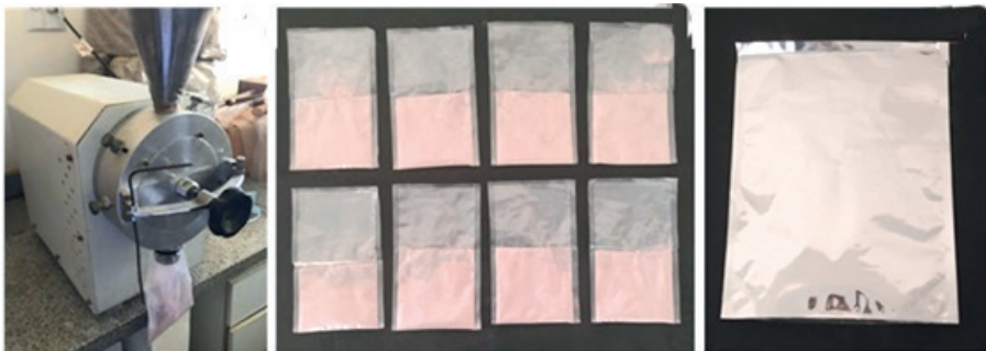
Figura 4. (a) Moagem das fatias, (b) acondicionamento em embalagens de polipropileno, e (c) armazenamento em embalagens laminadas.
