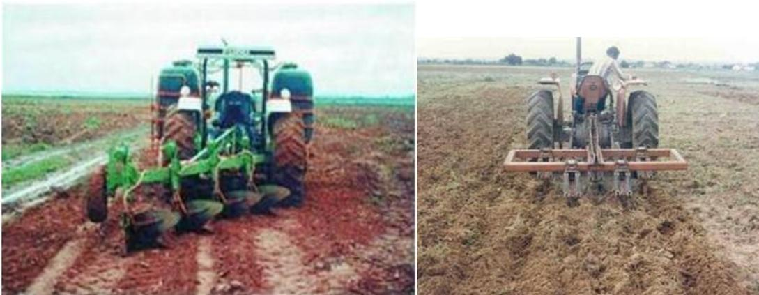
**Figura 34.** Preparo do solo com arado de aiveca ou arado escarificador. Foto: Odilon Reny Ribeiro Ferreira da Silva.
