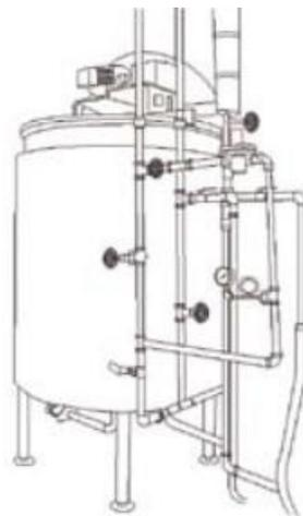
**Figura 81.** Tanque pasteurizador de gel de *Aloe vera*.
