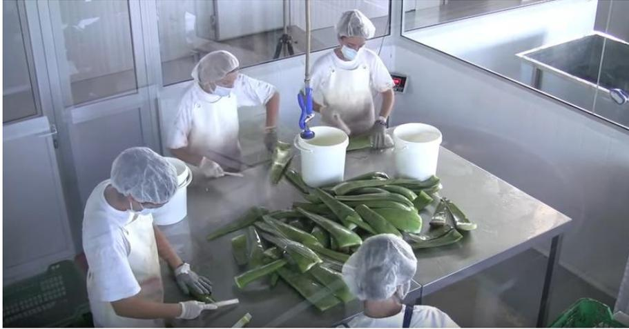
**Figura 76.** Filetagem manual com bastão de plástico duro (ou dorso da faca) entre a polpa e a casca de cada folha, tanto na sua face superior como a inferior, sobre uma mesa de aço inoxidável. Ambiente de filetagem aclimatizado com 16°C. Fotos: Empresa Santaverde, Andalucía, Espanha.
