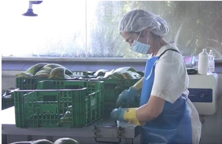
**Figura 75.** Movimento de folhas de *Aloe vera* do tanque de aço inoxidável para a cesta de plástico, quando são aparadas manualmente as suas extremidades de base e ápice (A;B), sendo aparadas mecanicamente as borda laterais (espinhos; C). Fotos: Empresa Santaverde, Andalucía, Espanha.
