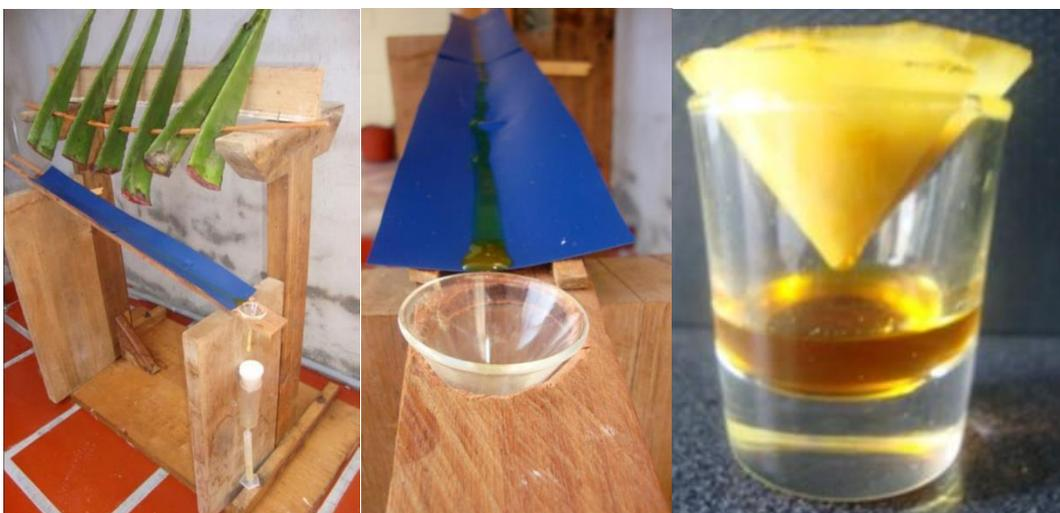
**Figura 82.** Processo de extração do látex de folhas cortadas de *Aloe vera* por gravidade (escorrimento do látex na canaleta inclinada e, no final, um copo coletor com papel de filtro) em condições de laboratório. Fotos: Danny Raúl Prado Orozco (2015).
