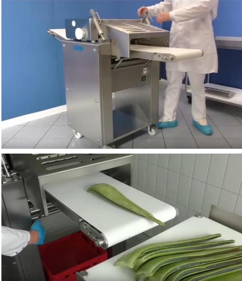
**Figura 77.** Máquina mecânica de filetagem de folhas de *Aloe vera* de fabricação alemã que somente elimina uma superfície da casca da folha de cada vez ou passagem.
