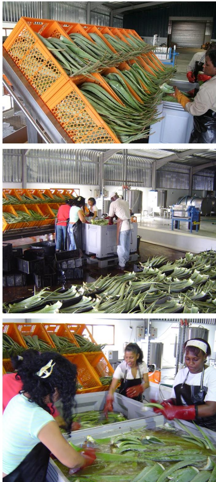
**Figura 72.** Seleção e lavagem da superfície das folhas de *Aloe vera* na parte interna da unidade de processamento industrial.
