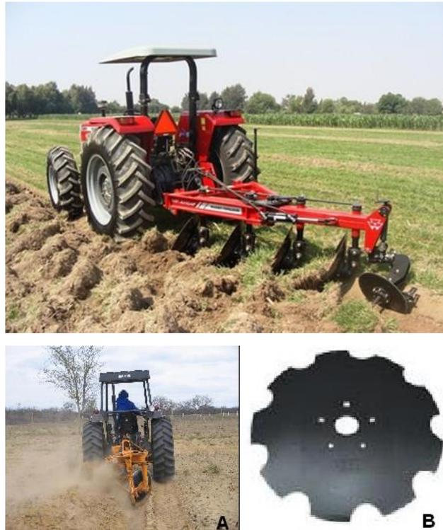
**Figura 35.** Preparo do solo com arado de discos (A) e modelo de disco de arado com perfil recortado (B). Foto: José Barbosa dos Anjos.
