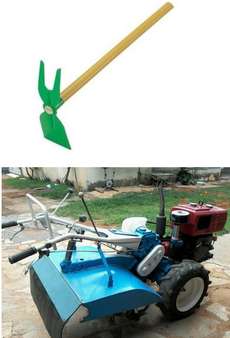
**Figura 55.** Sacho com duas pontas e cabo em madeira, para trabalhos leves de capinas em leirões cultivados com *Aloe vera*; e B) micro trator tobata com enxada rotativa.
