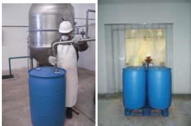
**Figura 84.** Envasado de gel em depósito de aço inoxidável e seu armazenamento em câmara fria.
