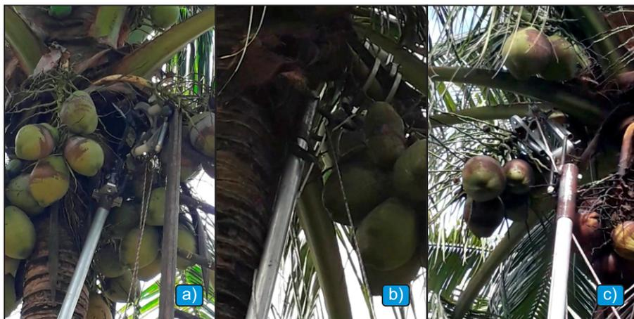
**Figura 4.** Ensaios do protótipo: a) Haste de colheita combinada com a foice b) Haste de colheita sem a foice e com a garra em posição invertida c) Haste de colheita sem a foice e a garra na posição original.
