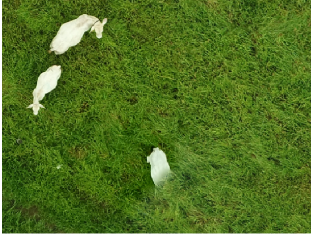
Figura 9: Artefato indesejados produzidos pelo pipeline fotogramétrico. É possível ver que, no processo de fusão de imagens e mapeamento de texturas, parte do animal foi cortada. Artefatos similares ocorrem também na pastagem.
