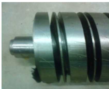
Figura 14. Trocador de calor de aço inoxidável parcialmente usinado (detalhe da aleta).
