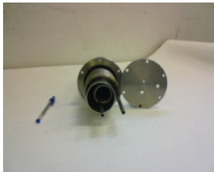
Figura 12. Trocador de calor a água semimontado (vista frontal).
