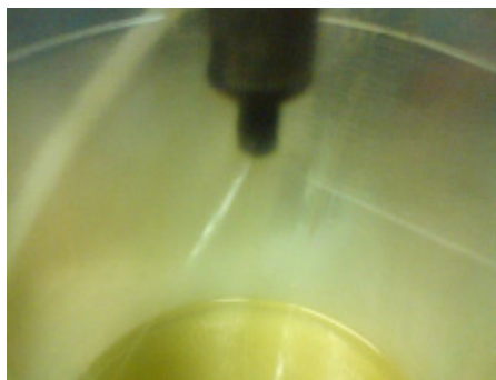
Figura 27. Teste do bico injetor do motor experimental com óleo de soja à temperatura ambiente.
