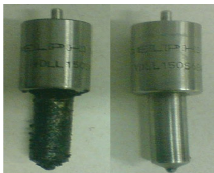
Figura 44. Bicos injetores carbonizados e limpo.
