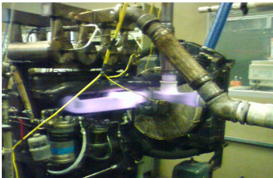
Figura 36. Coletor de escape do motor movido a óleo de soja em condição incandescente na rotação de 2000 rpm.
