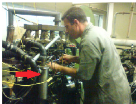
Figura 4. Motor com trocador de calor a água de arrefecimento.
