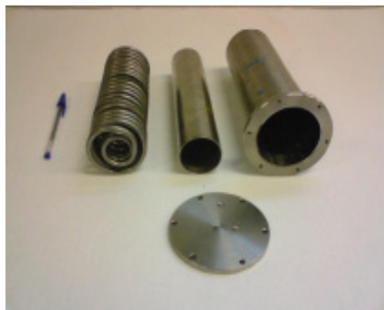
Figura 10. Trocador de calor a água desmontado (vista frontal).
