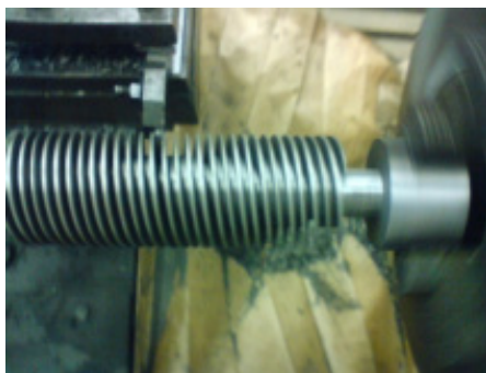
Figura 15. Trocador de calor de ferro fundido sendo usinado no torno.
