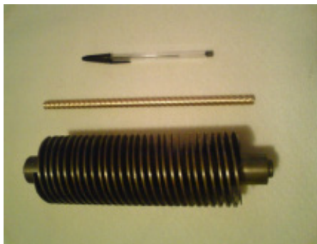
Figura 19. Trocador de calor e inserto sem tratamento superficial com níquel químico (vista individual).
