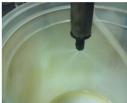
Figura 28. Teste do bico injetor do motor experimental com óleo diesel à temperatura ambiente.
