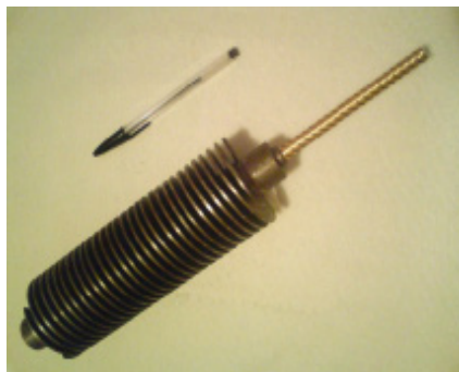
Figura 20. Trocador de calor e inserto sem tratamento superficial com níquel químico (vista em conjunto).
