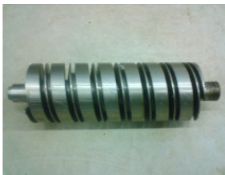
Figura 13. Trocador de calor de aço inoxidável parcialmente usinado (vista lateral).
