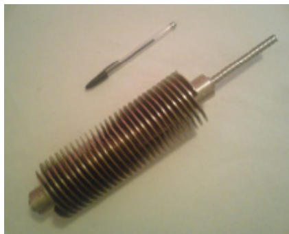
Figura 22. Trocador de calor e inserto tratados superficialmente com níquel químico (vista em conjunto).
