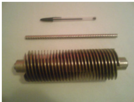
Figura 21. Trocador de calor e inserto tratados superficialmente com níquel químico (vista individual).
