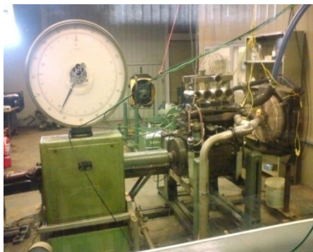
Figura 1. Motor em bancada dinamométrica.
