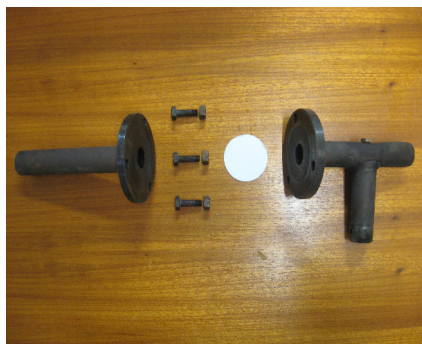
Figura 7. Detalhes do flange aberto com filtro de fibra de vidro.
