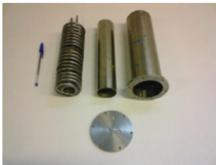
Figura 9. Trocador de calor a água desmontado (vista superior).
