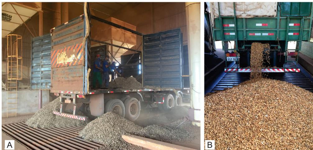
**Figura 8.** Carga de amendoim vinda do campo sendo descarregada na moega por gravidade com auxílio manual (A) e por esteira acoplada ao caminhão (B).
