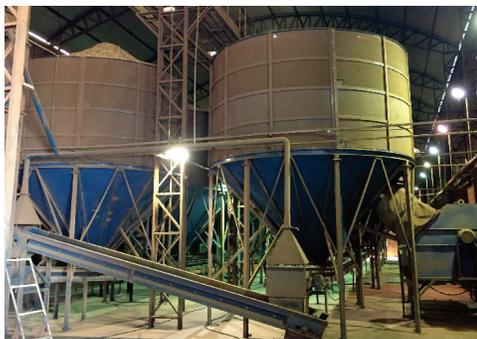
**Figura 11.** Secagem artificial do amendoim em silos.
