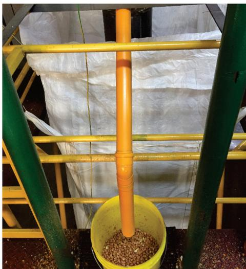
**Figura 17.** Exemplo de processo de amostragem automática de amendoim durante beneficiamento para nova análise do teor de aflatoxinas.
