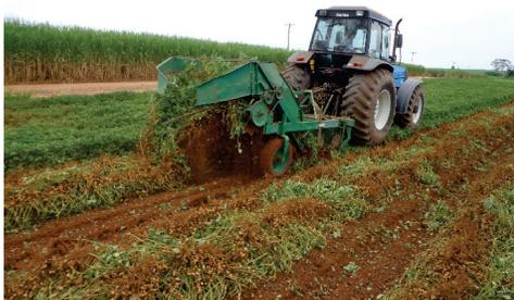
**Figura 3.** Processo de arranquio e inversão mecanizada do amendoim.
