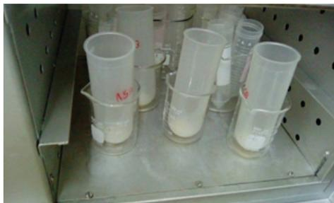
**Figura 5.** Tubos contendo amido isolado em secagem dentro da estufa de circulação de ar.
