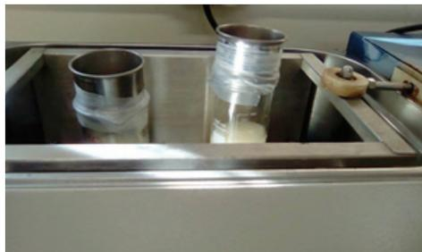
**Figura 3.** Filtração em peneira sob agitação do material triturado e homogeneizado.
