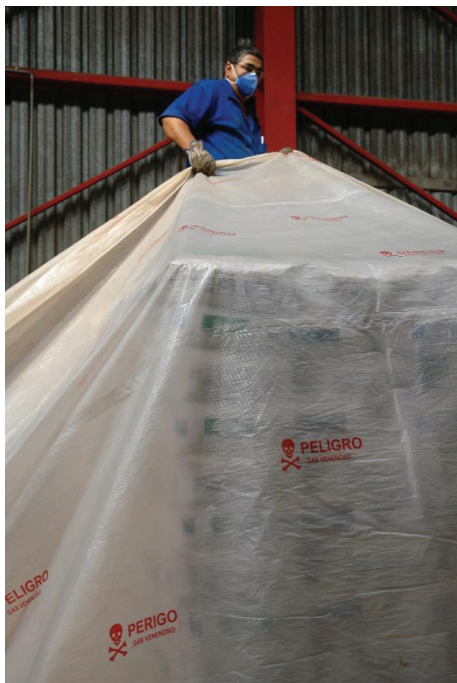
Figura 15. Cobertura das sacarias com lona plástica apropriada com espessura mínima de 150 micra.
