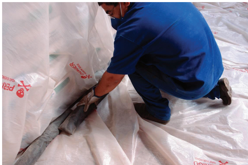
Figura 16. Cobertura das laterais da lona com “cobras de areia”.
