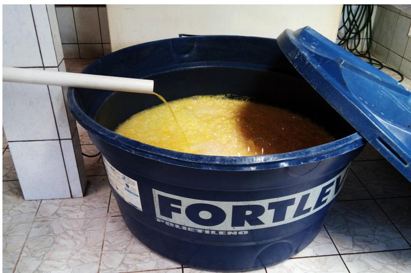
**Figura 7.** Fermentação da manipueira em tanques de polietileno.
