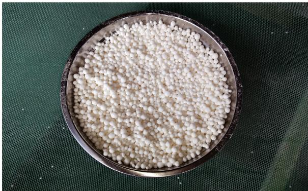
**Figura 3.** Pelotas feitas dentro da encaroçadeira tipo betoneira de aço inoxidável.
