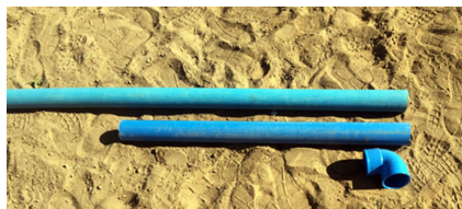
Figura 12. Tubulação e conexões de PVC de 75 mm.
