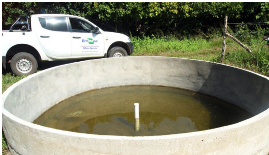
Figura 41. Tanque sendo testado quanto a possíveis infiltrações.
