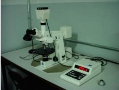
Figura 9. Microscópio petrográfico acoplado a um sistema de aquisição de imagens. Foto: Miguel Cooper.
