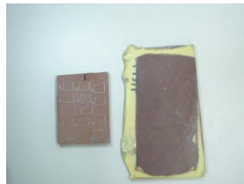
Figura 8. Blocos polidos utilizados para estudos de análises de imagens (observam-se as áreas desenhadas para aquisição da imagem). Foto: Miguel Cooper.
