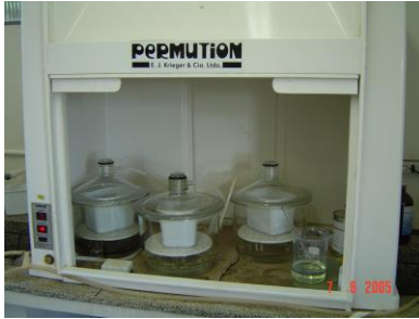
Figura 3. Sistema de impregnação utilizando dessecadores e vácuo. Foto: Miguel Cooper.
