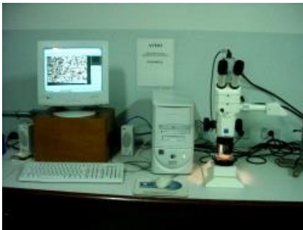
Figura 11. Sistema de análise de imagens com câmera fotográfica digital acoplada a uma lupa binocular. Foto: Miguel Cooper.
