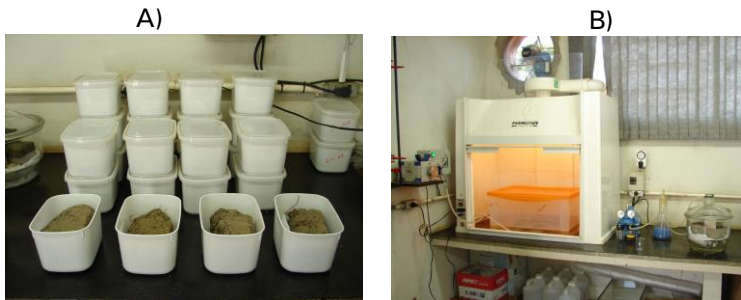
Figura 2. Remoção de água das amostras. A) Secagem ao ar; B) sistema de troca de água por acetona. Fotos: Miguel Cooper.
