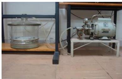
Figura 5. Sistema para solvatação com etilenoglicol a frio, composto por um dessecador e uma bomba de vácuo. Fotos: Gilson Gregoris.
