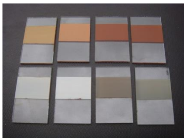
Figura 4. Alteração da cor de amostras de argila após a desferrificação: amostras não tratadas (superiores) e desferrificadas (inferiores).
