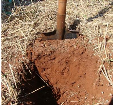
Figura 2. Detalhe da retirada da amostra de solo no campo com pá de corte. Foto: Adoildo da Silva Melo.
