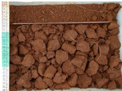
Figura 4. Camadas de solo com características morfológicas distintas identificadas e separadas. Foto: Adoildo da Silva Melo.
