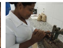
Figura 2A. Prensa utilizada na retirada da casca da semente de castanheira-do-brasil. Foto: Cássia Ângela Pedrozo
