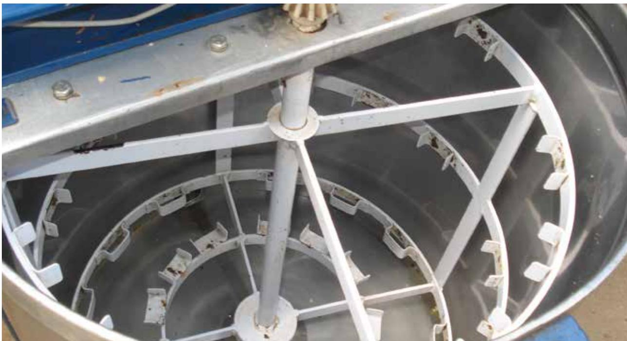
**Figura 47.** Parte interna da centrifugadora, com grade para colocação dos quadros com favos de mel.
