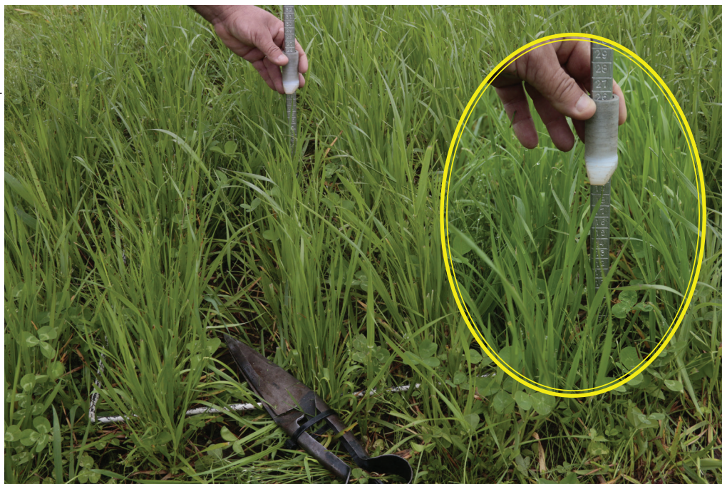
Figura 2. Bastão graduado, quadro e tesoura utilizados para medir a altura e a massa de forragem.
