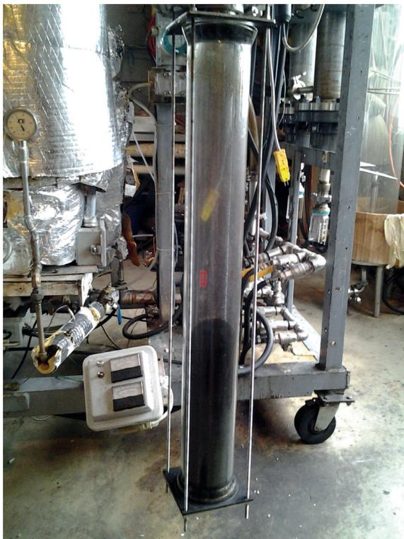
**Figura 12.** *Biochar*, coletado em um recipiente abaixo de um ciclone que faz a separação gás-sólido, localizado após o reator de pirólise.
