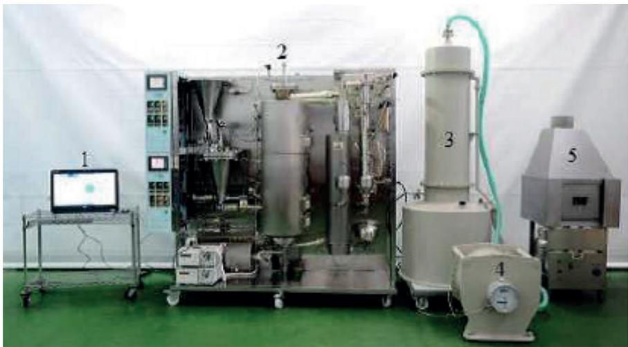
**Figura 13.** Planta piloto de gaseificação e pirólise instalada na Embrapa Agroenergia, composta por: (1) sistema de aquisição de dados e controle do processo; (2) reator de leito fluidizado com aquecimento elétrico; (3) lavadora de gases; (4) medidor de fluxo volumétrico e (5) queimador de gases.
