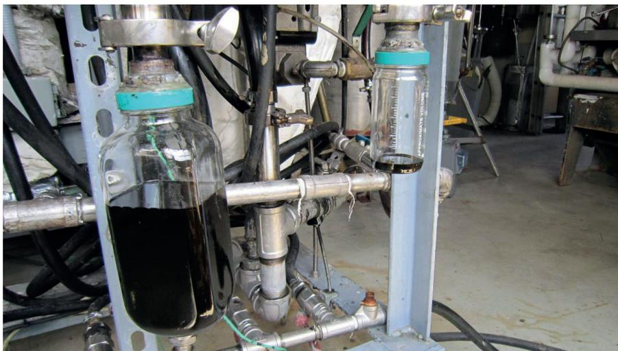
**Figura 8.** Sistema para coleta do bio-óleo durante um experimento da pirólise rápida sem reciclo. Foto: Anna Leticia Montenegro Turtelli Pighinelli.
