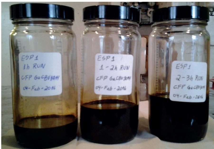
**Figura 11.** Bio-óleo coletado dos precipitadores eletrostáticos em diferentes tempos de processamento: durante a primeira hora de processamento (1 h), durante a segunda hora de processamento (1 h – 2 h) e durante a terceira hora de processamento (2 h – 3 h).
