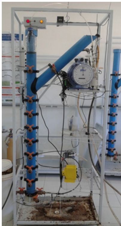
Figura 3. Esquema e fotografia do reator UASB metanogênico em escala de laboratório.
